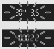
Con muy poca luz o con luz muy brillante, la indicación de la velocidad de obturación y de la apertura parpadeará cuando presione el disparador hasta la mitad, como se muestra en la figura. Con poca luz (30" 3.5), aumente la sensibilidad ISO (p. 62) o utilice el flash (p. 64). Con luz muy brillante (4000 22), reduzca la sensibilidad ISO.
