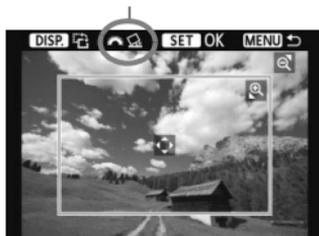
Puede recortar la imagen e imprimir solamente la parte recortada, como si se hubiera recompuesto la imagen. **Realice el recorte justo antes de imprimir.** Si ajusta el recorte y, a continuación, los ajustes de impresión, puede que deba volver a ajustar el recorte.
