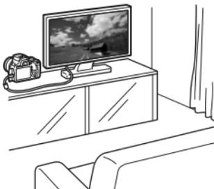
Utilice el cable AV que se proporciona o un cable HDMI HTC-100 (se vende por separado) para conectar la cámara a un aparato de TV. Así podrá reproducir los vídeos grabados y las fotos en el aparato de TV.
